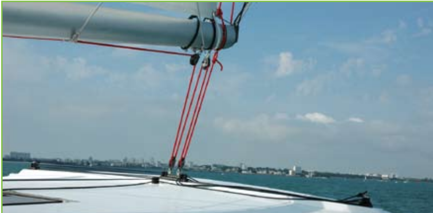
• Le « bimini » rigide à l'arrière duquel est positionné le rail d'écoute de GV
