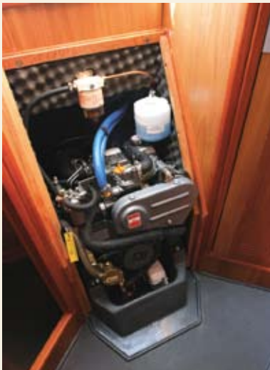
Le moteur est un 14 Ch Yanmar
