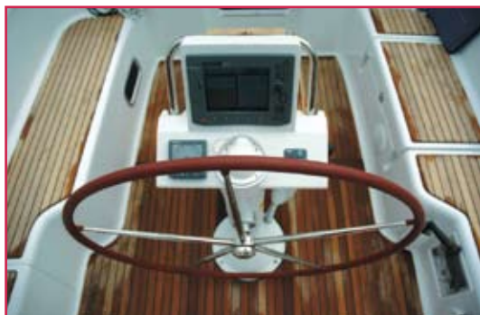
La console de barre intégrant l'écran d'un traceur de cartes.
