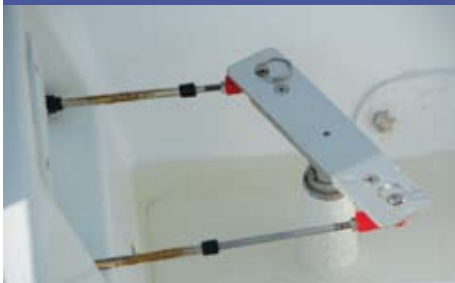
Le palonnier auquel se fixent les drosses reliant le stick de pilotage.
