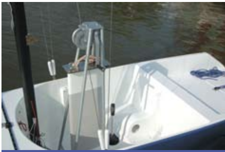
La chèvre et le treuil d'installation de la quille derrière laquelle on remarque le stick de pilotage.
