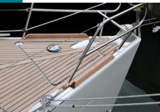
Le guindeau est encastré dans la baille à mouillage.
