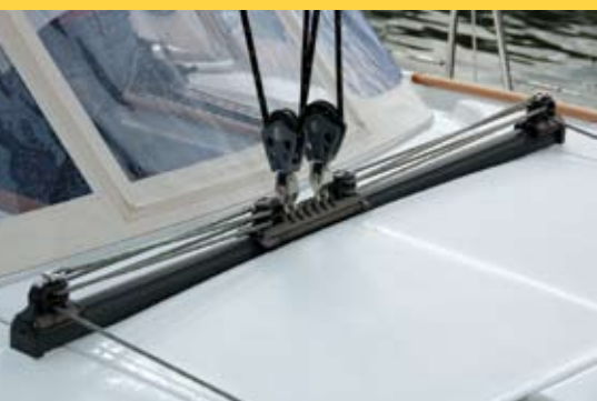
L'écoute de grand-voile dont la barre d'écoute est fixée sur le rouf.
