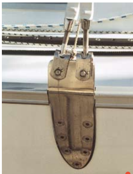
Puissant renfort de cadènes
