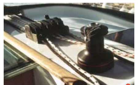
Retour des manœuvres sur un winch bien accessible
